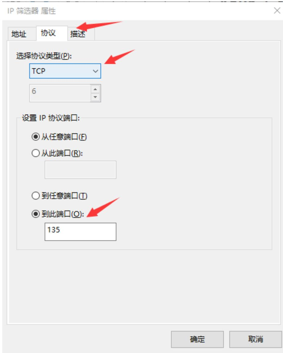
重复第 7 个步骤，添加 TCP 端口 135、139、445。添加 UDP 端口 137、138。添加全部完成后，确定。
